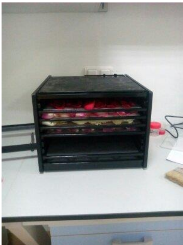
Slika 6. Prikaz sušenja latica ruža u dehidratoru (Excalibur dehydrator 4926T, SAD)
