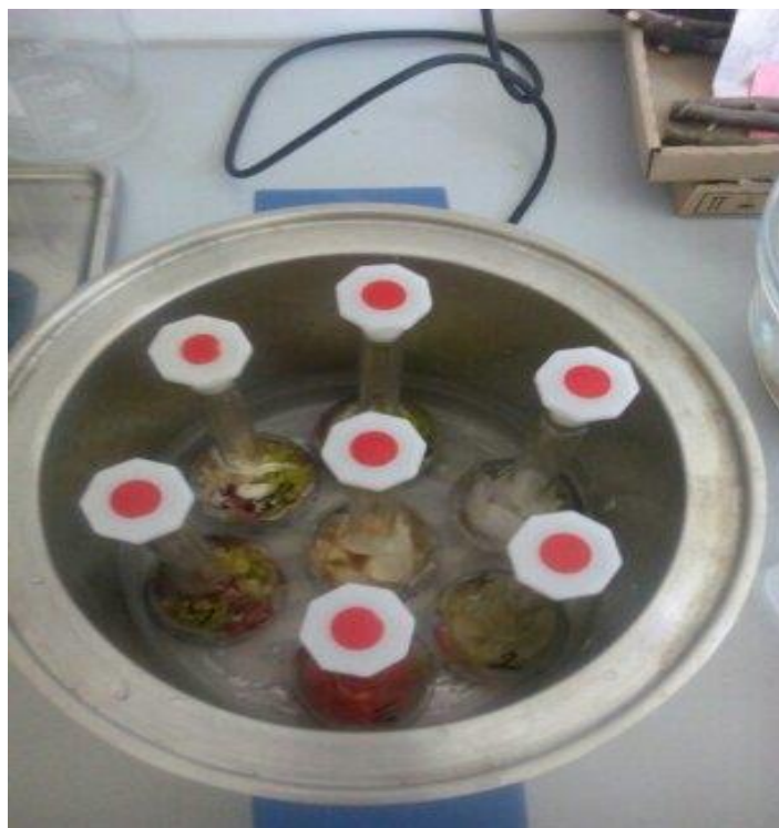
Slika 12. Prikaz kuhanja uzorka u parnoj kupelji u svrhu određivanja škroba (Snimila: Ivana Filipović)
