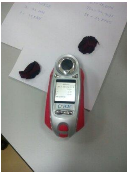
Slika 14. Određivanje boje pomoću kolorimetrom (Colortec PCM)
