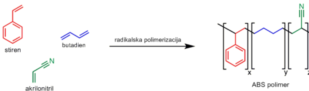
Slika 23. Radikalna polimerizacija kojom nastaje ABS iz monomera stirena, akrilonitrila i butadiena [18]
