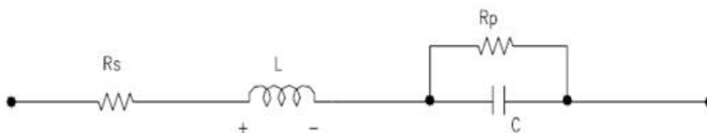
Slika 2.6. Ekvivalentni krug kondenzatora
