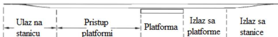
Slika 13. Stanica s jednom platformom i jednim prilazom
