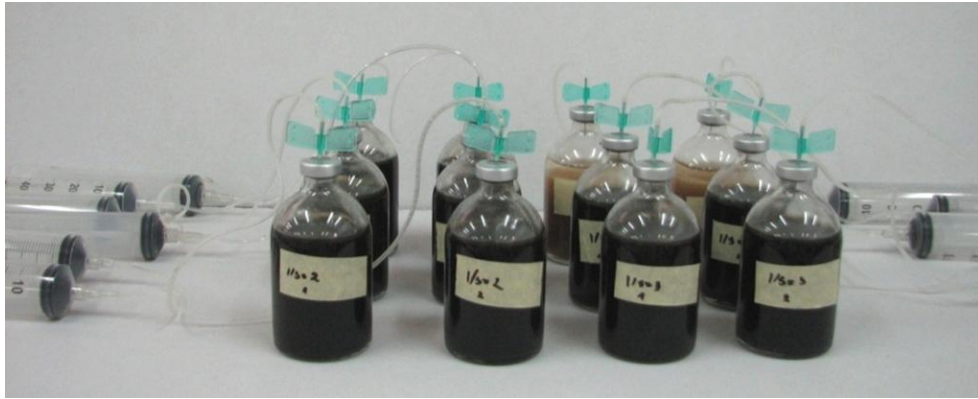
Slika 3.3. Fotografski snimak priređenog BMP testa.
