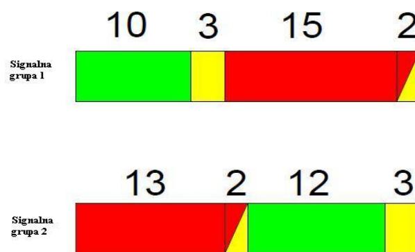
Slika 30. Signalni plan predloženog stanja raskrižja Ulice K.Filića-M.Krleže
