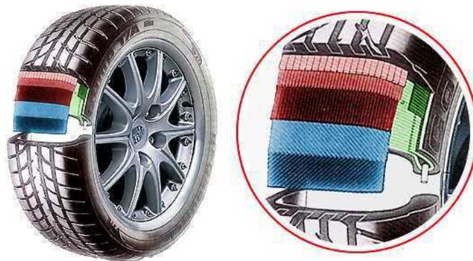
Slika 4. Sastavni dijelovi radijalnog pneumatika, [7]
