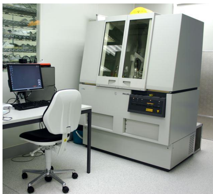
Sl. 3.3. Rendgenski difraktometar XRD-XPRT PRO (laboratorij Hrvatskog geološkog instituta).
