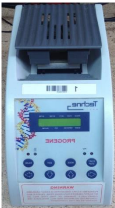
Slika 4. Uređaj za PCR (PCR-termoblok)
