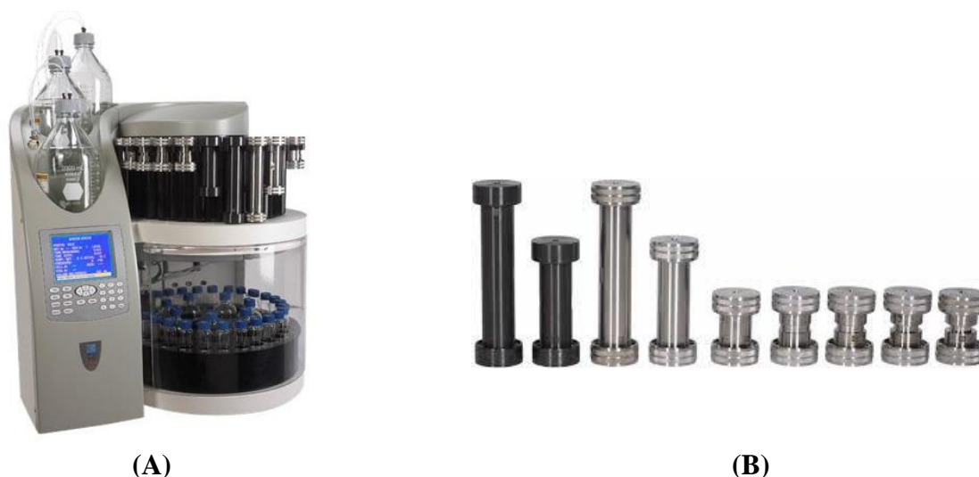
Slika 8. Sustav za ubranu ekstrakciju otapalima pri povišenom tlaku (Dionex ASE 350) (A) i ekstrakcijske ćelije različitih volumena (B) (Anonymous 5., 2013)
