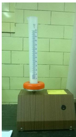
Slika 3.14. Uređaj za mjerenje gustoće nakon potresanja
