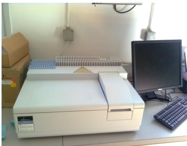
Slika 3.26. UV/VIS spektrofotometar Lambda 35 (PerkinElmer, Waltham, SAD) [22]
