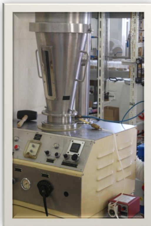
Slika 2.3. Fotografija granulatora s fluidiziranim slojem Uni-Glatt (Glatt GmbH, Binzen, Njemačka).
