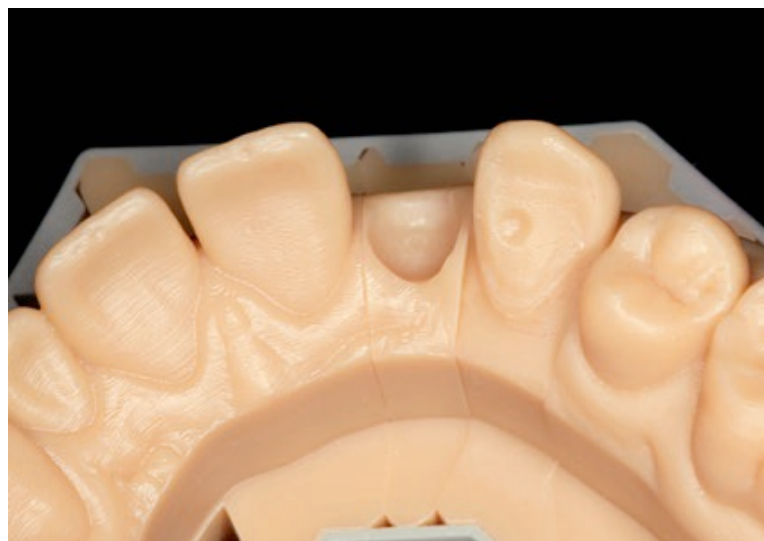
Slika 15. Stereolitografski izrađeni model na temelju digitalnog otiska dobivenog skenerom Lava C.O.S. Jasno se uočavaju slojevi polimerizacije. Preuzeto iz: (47)
