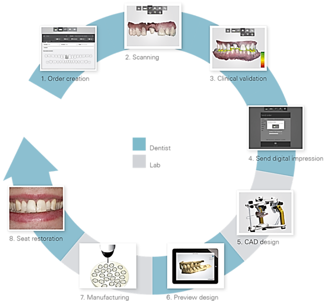
Slika 1. Tijek digitalizirane izrade protetskog rada u laboratoriju. Preuzeto iz: (24)
