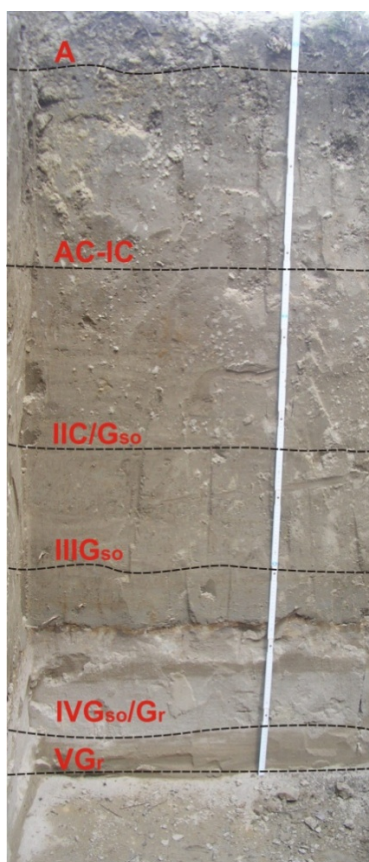
Slika 6.1. Pedološki profil tla sa označenim horizontima, ukupne dubine 210 cm.
