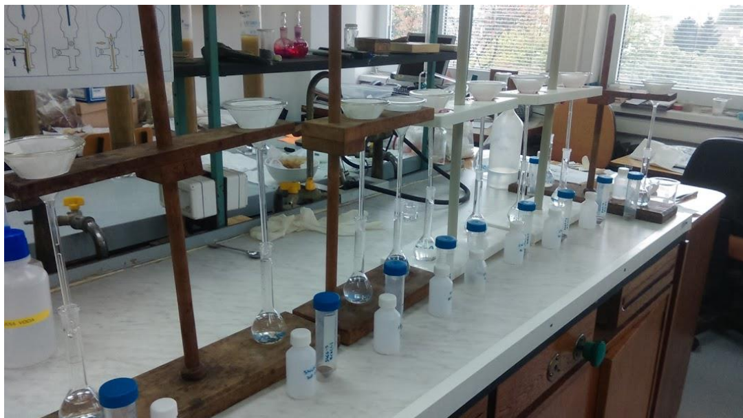
Slika 4-7. Filtriranje uzoraka tijekom sekvencijska ekstrakcijske analize (BCR)
