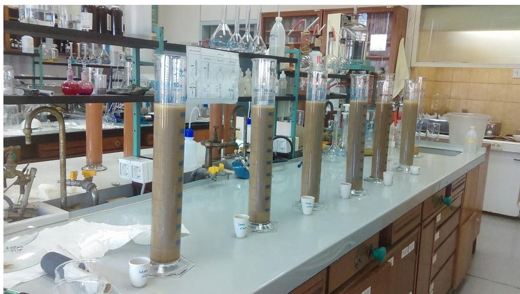
Slika 4-5. Izvlačenje frakcija < 2 \mu\text{m} (foto: Tin Borovčak)
