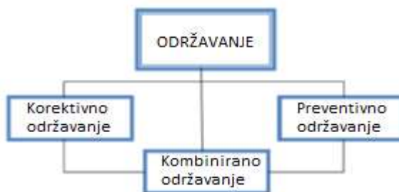
Slika 1. Model održavanja vodoopskrbnih sustava Fig. 1. Model of maintenance of water supply systems
