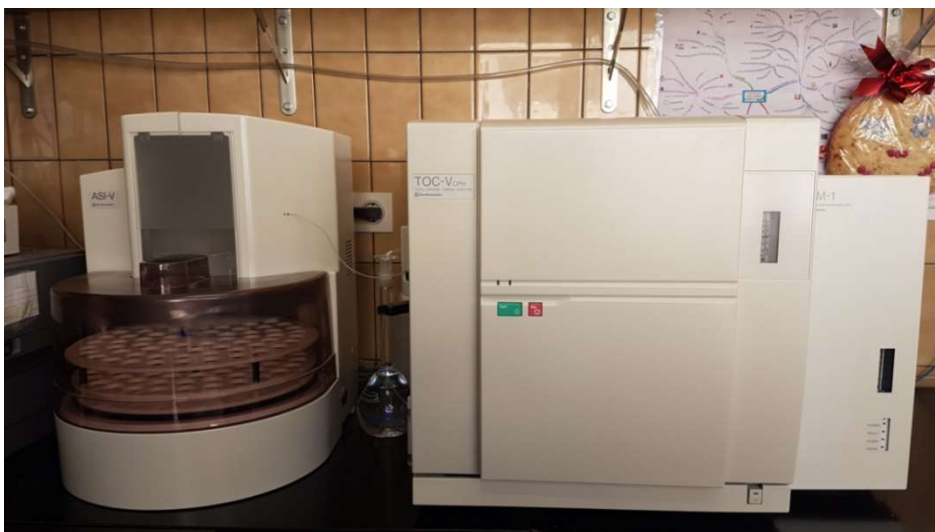
Slika 1. TOC-TN analizator, Shimadzu Fig. 1. TOC-TN analyzer, Shimadzu
