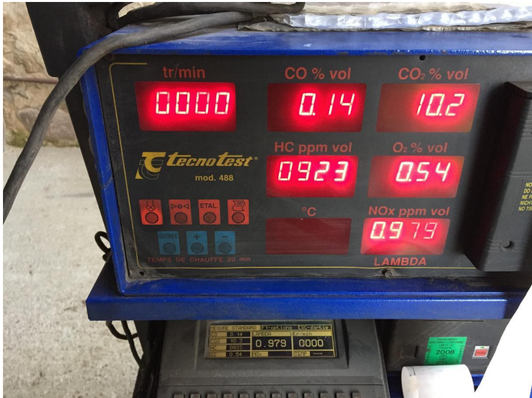
Sl. 2.28. – Primjer rezultata odrađenog testa ispušnih plinova [23]
