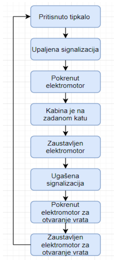
Slika 2.3. Blok dijagram rada dizala
