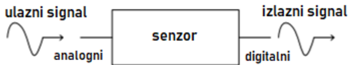
Slika 2.1. Blok dijagram senzora. [15]
