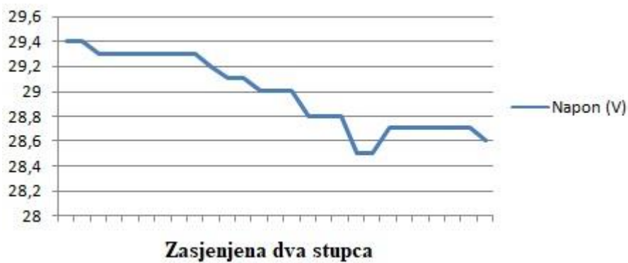
Slika 4.27. Promjena napona pri zasjeni dva stupca fotonaponskog modula.
