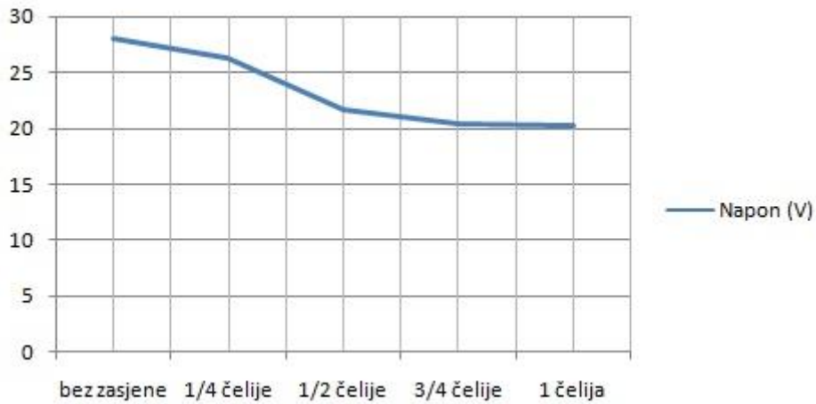
Slika 4.10. Promjena napona s obzirom na zasjenjenje četvrtina fotonaponske ćelije.
