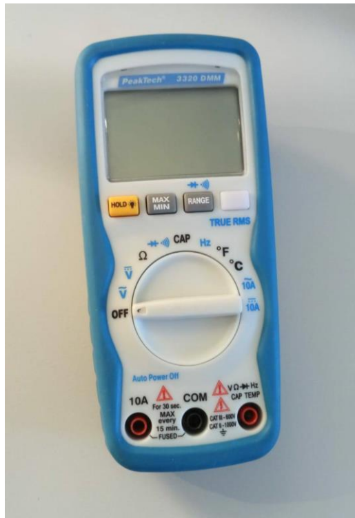
Slika 4.6. Mjerni uređaj PeakTech 3320 DMM
