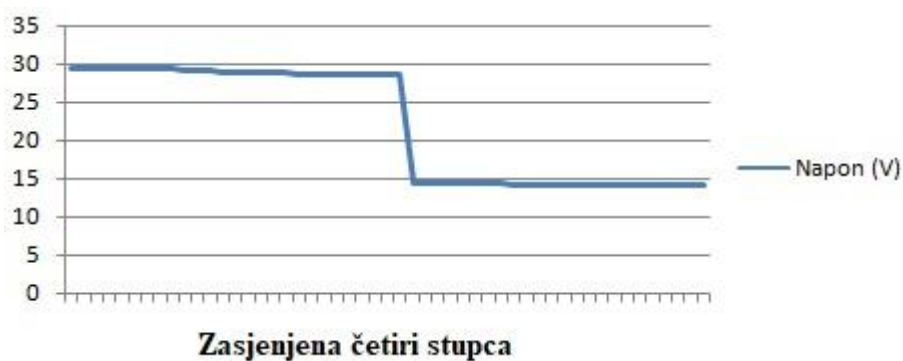
Slika 4.28. Promjena napona pri zasjeni četiri stupca fotonaponskog modula.
