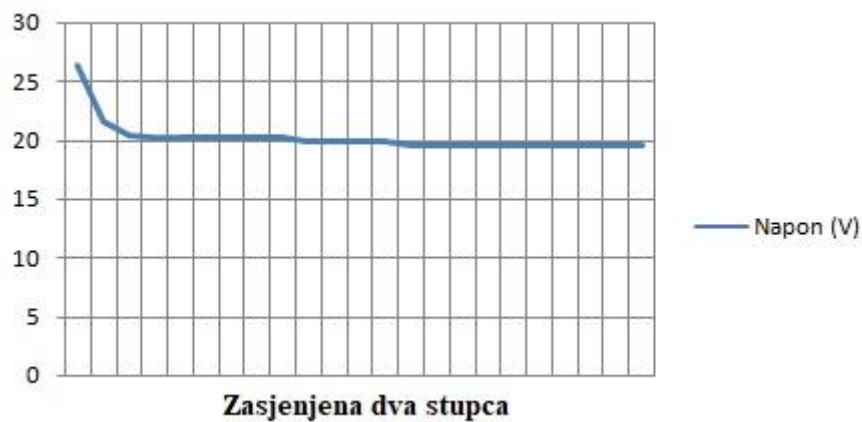
Slika 4.11. Promjena napona pri zasjeni dva stupca fotonaponskog modula.
