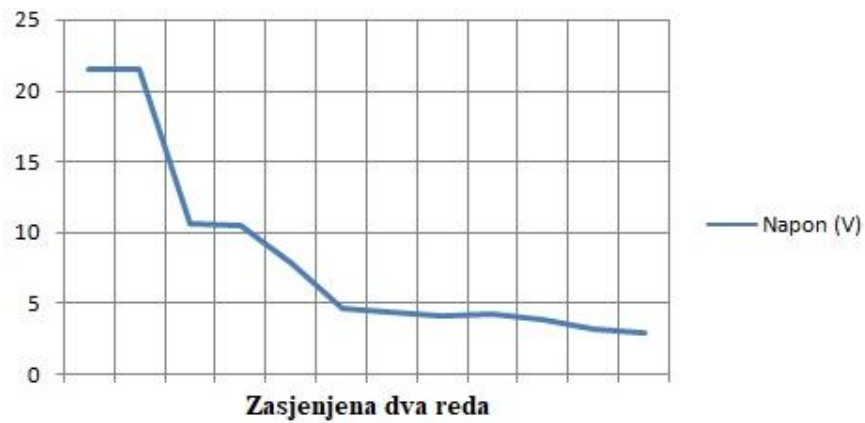
Slika 4.15. Promjena napona pri zasjeni dva reda fotonaponskog modula.
