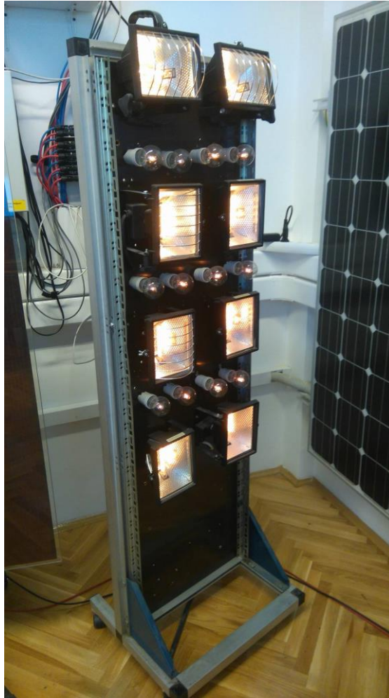
Slika 4.9. Laboratorijski izvor svjetlosti
