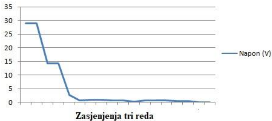
Slika 4.31. Promjenu napona pri zasjeni tri reda fotonaponskog modula.
