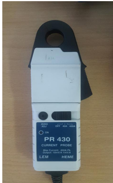
Slika 5.5. strujna kliješta LEM PR430
