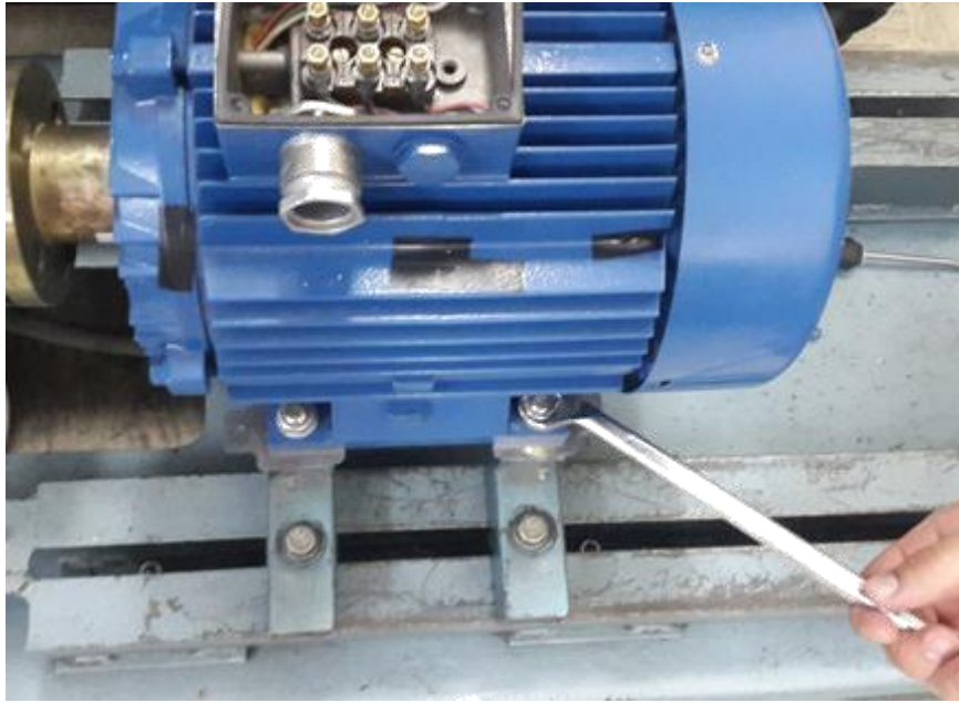
Slika 4.9. Skidanje motora s postolja
