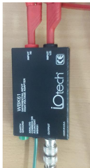
Slika 5.6. Naponska mjerna sonda IOTECH WBK61
