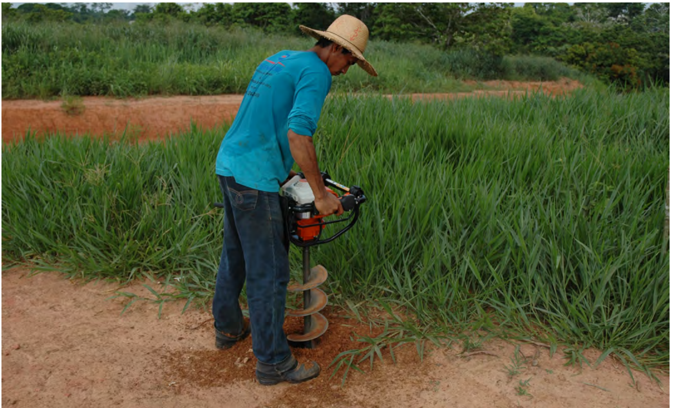
Figura 34. Perfuração de solo com perfurador mecânico marca Sthil BT121 com broca helicoidal também utilizado no coveamento para seringueira.
