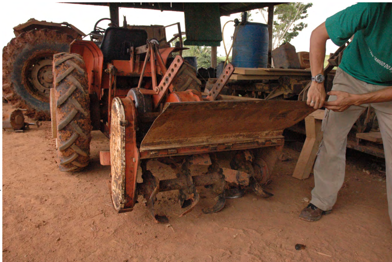
Figura 20. Rolo-faca acoplado a minitrator utilizado no preparo final dos canteiros no viveiro de porta-enxerto.
