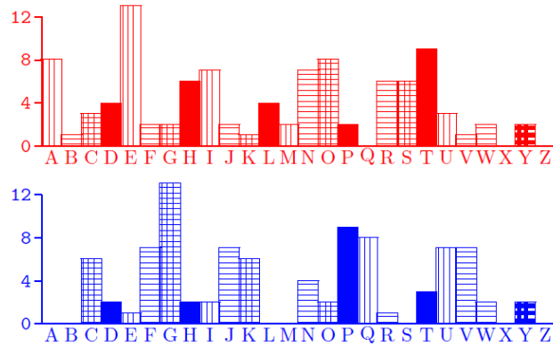
Slika 3.4: Usporedba učestalosti otvorenog teksta i šifriranog teksta za svako šesto slovo primjera Vigenereove šifre, počevši s prvim slovom
