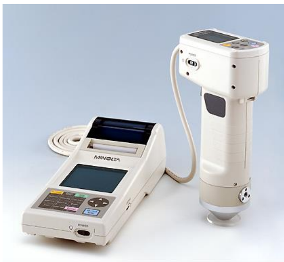
Slika 10 Kromametra CR 400 (Minolta, Japan)
