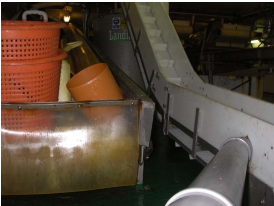
Figur 12: Lever og indvolde fra kryvji paun, indløb på dræn og transport band
