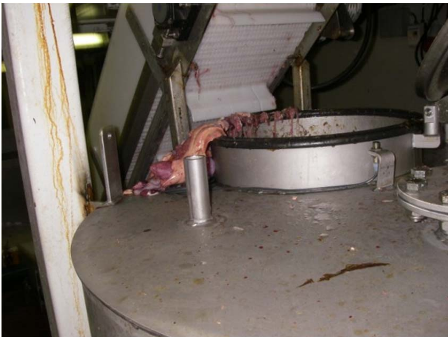
Figur 17: Dræn og transport bånd afleverer til ensilerings tank gennem mande hul, 400mm ø
