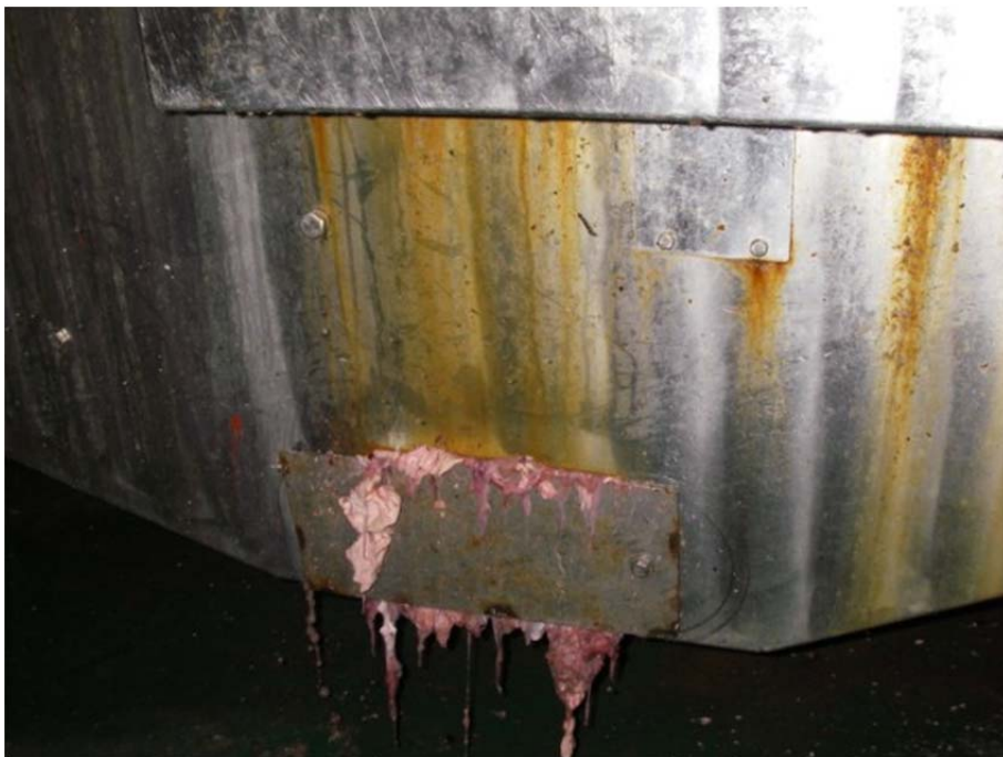
Figur 15: Lukket lem på kryvji maskine, der forhindrer lever og indvolde i at løbe ud på dækket
