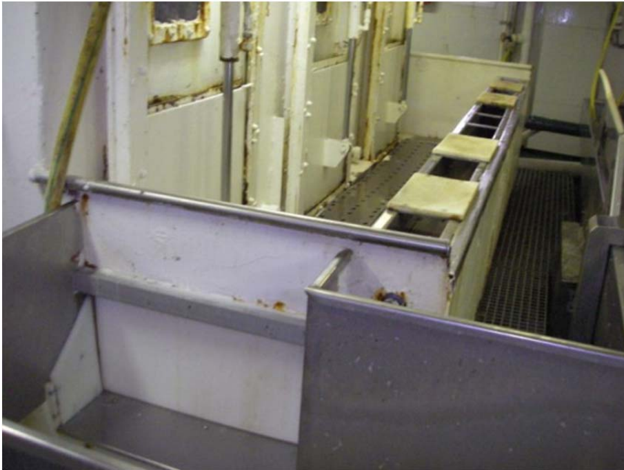
Figur 9: Kryvji paun og udløb til transport bånd til maskin kryvjing
