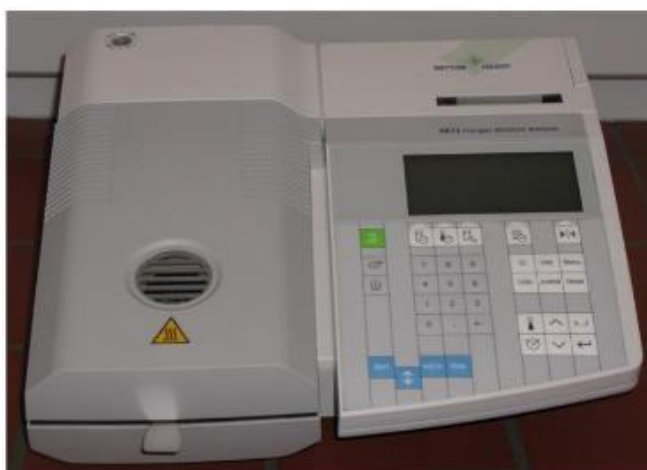
Slika 3.5. Halogeni analizator vlage
