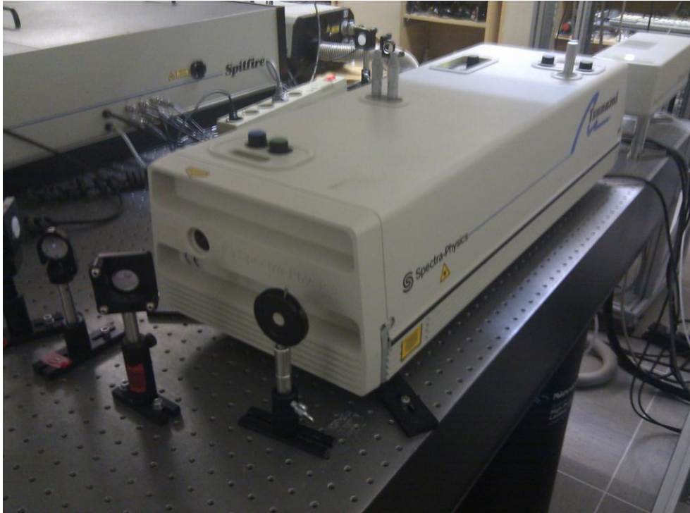
Slika 18. Femtosekundni laser (Millenia, Spectra Physics, SAD).
