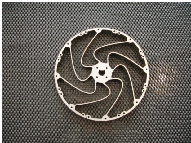
Slika 22. Složeni oblici dobiveni upotrebom EDM-a (preuzeto iz 112)
