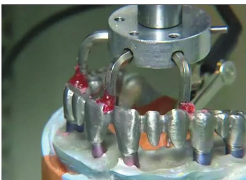
Slika 23. a) Obrada prečke nošene implantatima na EDM-u; b) Obrada osnovne metalne konstrukcije metal-keramičkog nadomjeska na EDM-u (obje slike preuzete iz 109)
