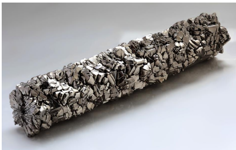
Slika 14. Šipka kristaliziranog titana, visoke čistoće 99.995 % (preuzeto iz 78)
