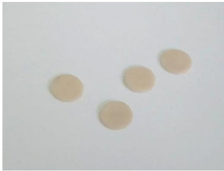
Slika 68. Gotove pločice \text{Li}_2\text{S}_2 jezgrene keramike IPS e.max Press
