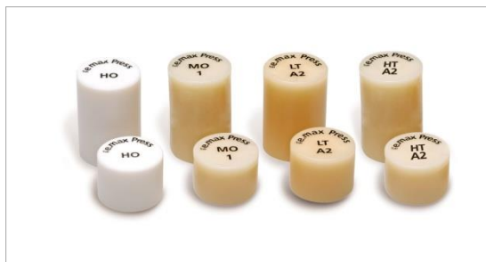
Slika 55. Keramički valjčići IPS e.max Press (Ivoclar Vivadent) u dvije veličine i četiri stupnja translucencije, odnosno opaciteta (preuzeto iz 178)
