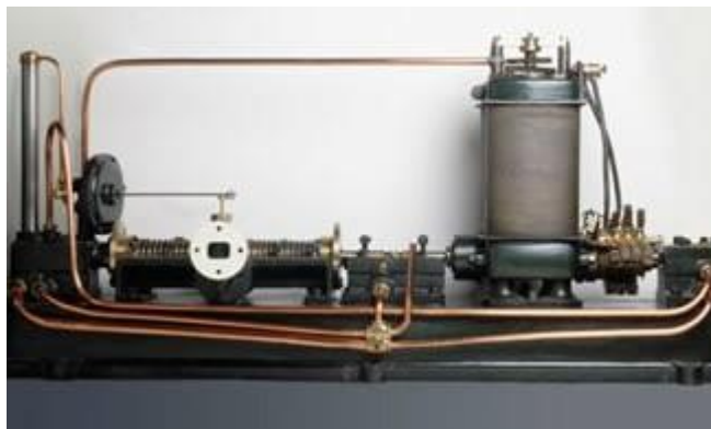
Slika 6. Parsonsova parna turbina[2]
