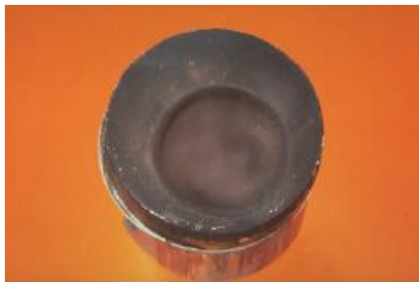
Slika 17. Erozijska površina uzrokovana propuštanjem rasprskavača goriva [7]
