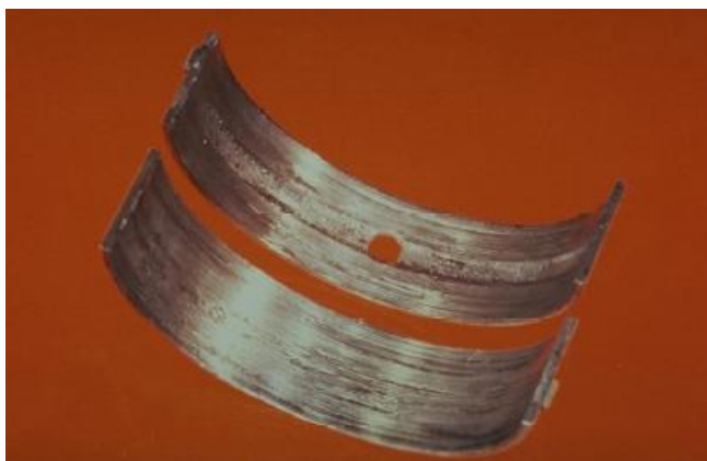
Slika 29. Adhezijsko trošenje do aluminijskog sloja [6]
