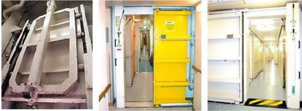
Slika 12. Vrste vodonepropusnih vrata (Prema: Ivošević, Špiro, Održavanje i bezbjednost broda , 2016.)
