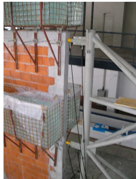
Slika 3.10. Prikaz položaja hidrauličkih preša
