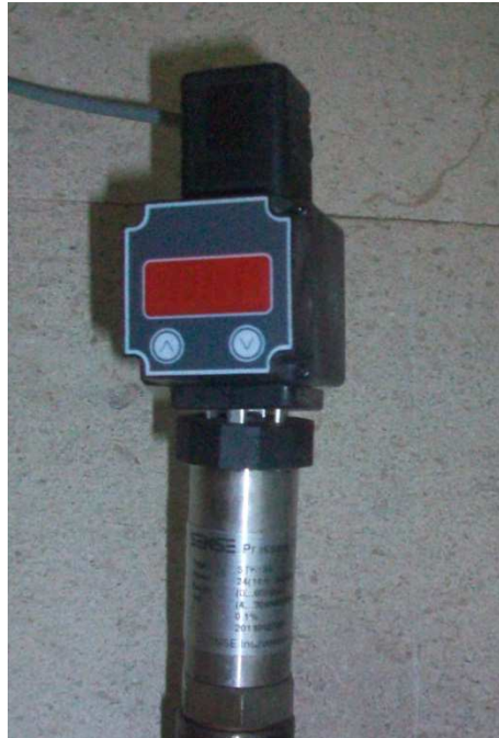
Slika 3.9. Senzor tlaka (manometar) za mjerenje sile
