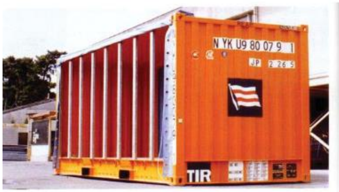
Slika 5. Kontejner s otvorenim krovom i stranicama
