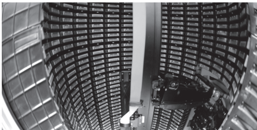
Fot. 2. Przykład rozbudowanej i całkowicie zautomatyzowanej biblioteki taśmowej Źródło: (ChrisDag, 2009).
