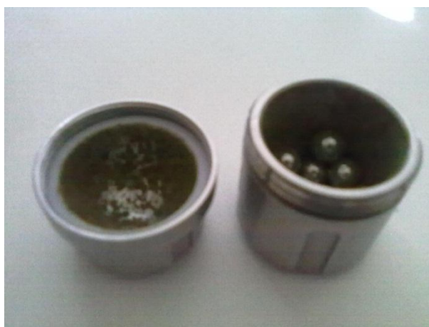
Fig. 2.3 – Cápsula do moinho de bolas, após a moagem de Scenedesmus obliquus durante 3:50min com 8 bolas de 10 mm de diâmetro.
