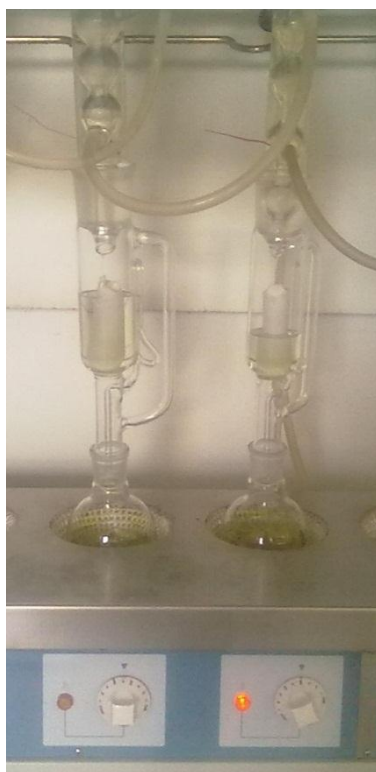
Fig. 2.4 – Extracção de lípidos pela técnica de Soxhlet.
