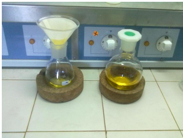
Fig. 2.5 – Filtração da solução do balão de destilação utilizado na extracção (direita) para o balão destinado à remoção do solvente e consequente determinação do conteúdo em lípidos (esquerda).
