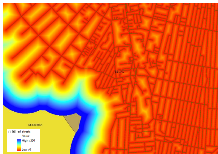
Figura 6.93 Parte do resultado do cálculo das distâncias Euclidianas à rede de estradas dos 9 municípios.
