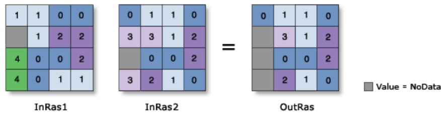
Figura 5.17 Ilustração da função Set Null , através da operação Setnull(InRas1 = 4, InRas2) (Fonte: ESRI).
