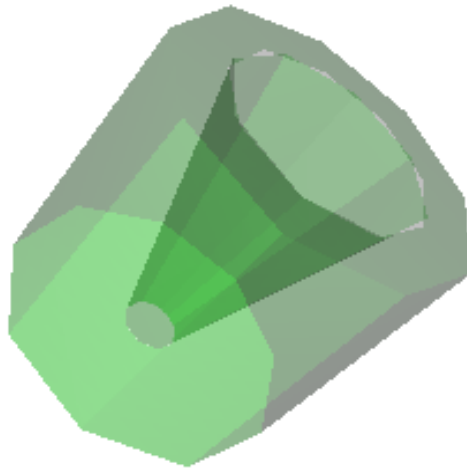
Rysunek 3.2 Wizualizacja kolimatora pierwotnego uzyskana za pomocą nakładki graficznej MCNPX.
