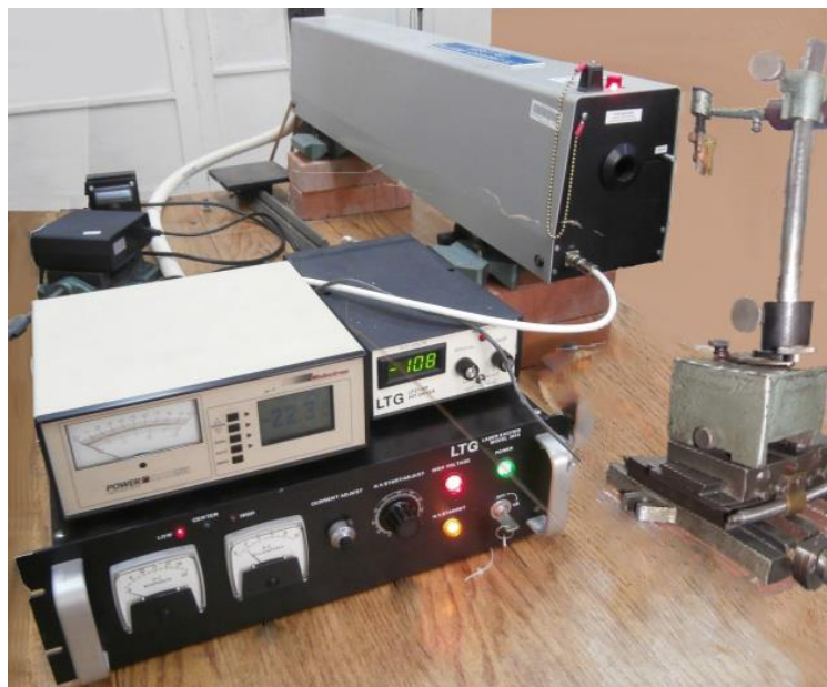
Rys. 3-6 Zdjęcia stanowiska technologicznego do wytwarzania heterostruktur za pomocą lasera LTG70626G.
