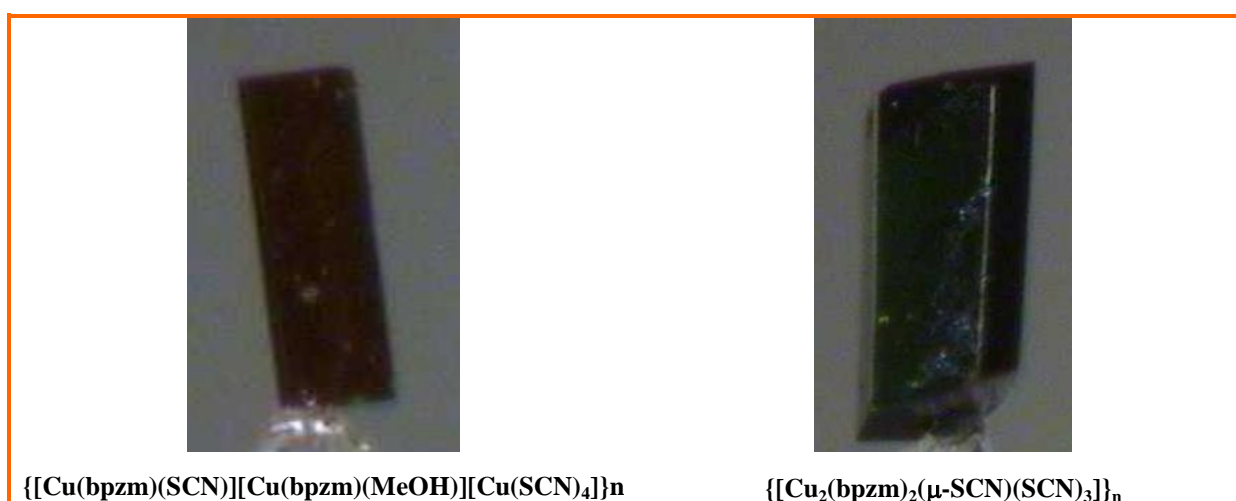
Rys 64. czerwone kryształy \{[\text{Cu}(\text{bpzm})(\text{SCN})][\text{Cu}(\text{bpzm})(\text{MeOH})][\text{Cu}(\text{SCN})_4]\}_n oraz zielone kryształy \{[\text{Cu}_2(\text{bpzm})_2(\mu\text{-SCN})(\text{SCN})_3]\}_n .
