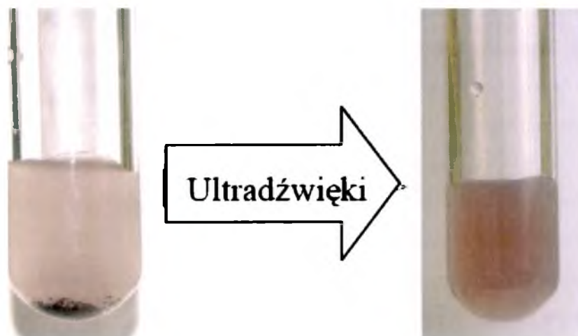
Rys. 5. Efekt dyspergowania katalizatora w polu ultradźwięków.
