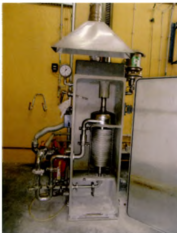
Rys. 22. Otwarta wirówka szybkoobrotowa z widocznym rotorem.
