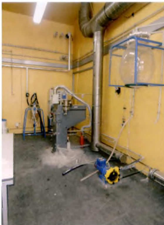
Rys. 21. Wirówka szybkoobrotowa, pompa perystaltyczna oraz naczynie naporowe na ługi jako część instalacji wykorzystywana do wydzielenia krzemionki koloidalnej.
