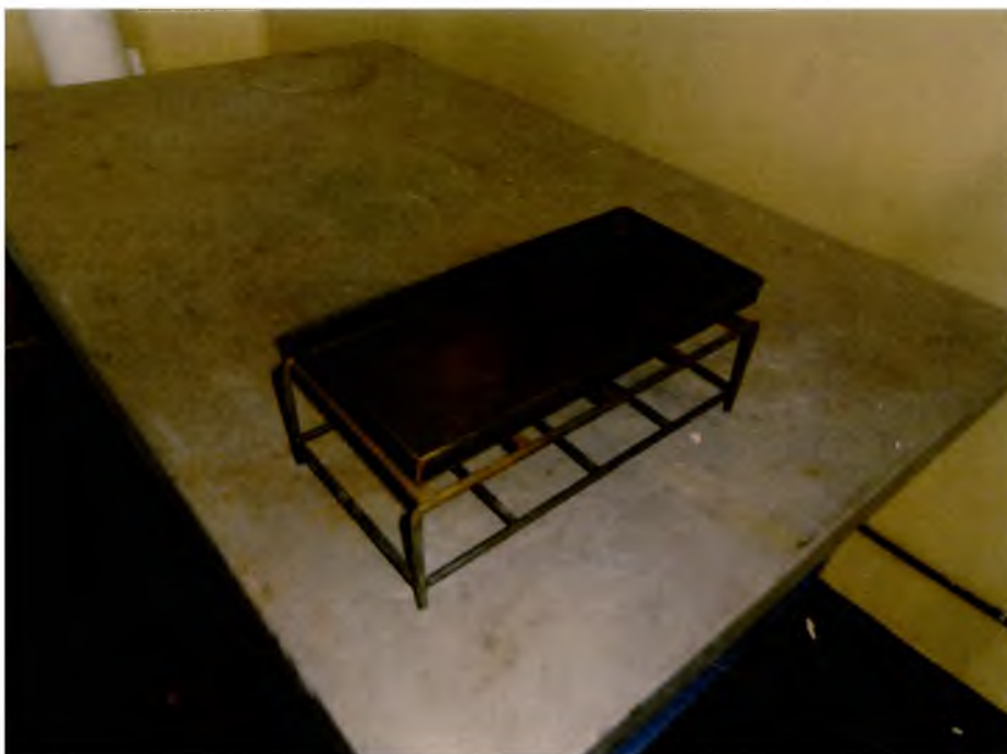
Rys. 27. Taca do pieca wodorowego na krzemionkę z naniesionym prekursorem metalu.
