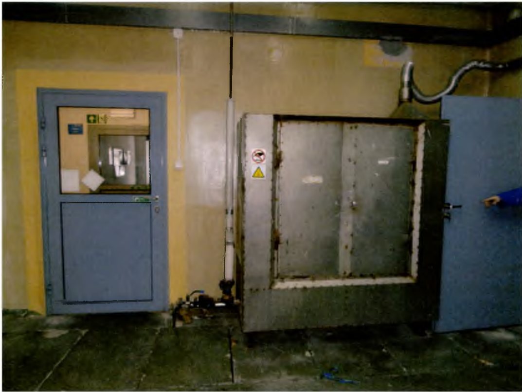
Rys. 25. Suszarka parowa wykorzystywana po procesie nanoszenia prekursora metalu na krzemionkę.
