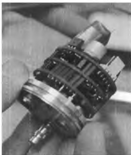
Rysunek 16: Moduł wysokiego napięcia igły fotonowej [fotografia własna].
