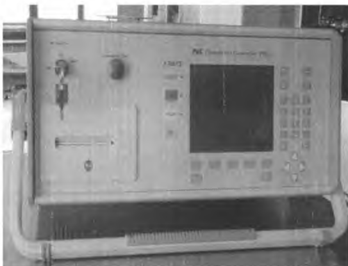
Rysunek 17: Moduł niskiego napięcia igły fotonowej [fotografia własna].
