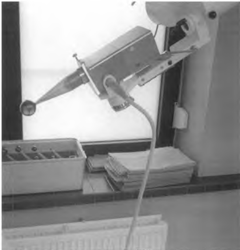
Rysunek 25: Zamontowanie aplikatora na korpusie igły fotonowej [fotografia własna].
