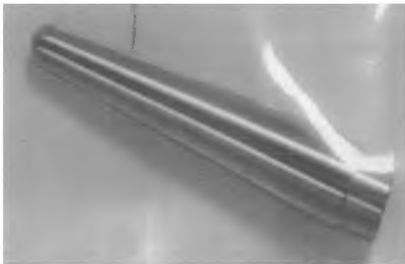
Rysunek 19: Berylowy stożek z układu konstruowanego w Narodowym Centrum Badań Jądrowych w Świerku [fotografia własna].
