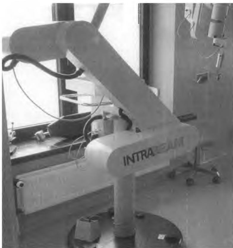
Rysunek 26: Ramię robota, do którego mocowany jest korpus igły [fotografia własna].
