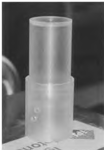
Rysunek 32: Aplikator do pomiarów rozkładów kątowych dawek generowanych przez igłę fotonową.
