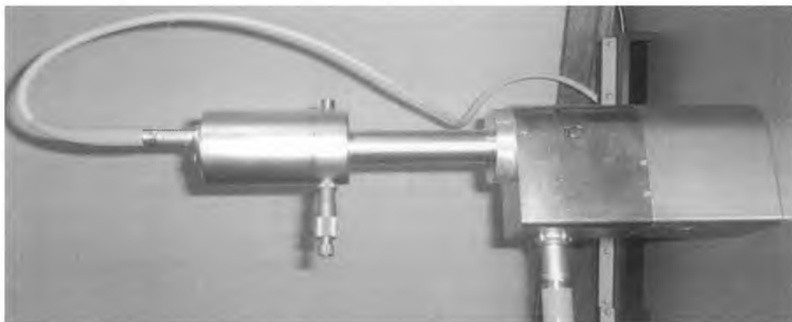
Rysunek 22: Sposób mocowania nakładki PAICH [fotografia własna].
