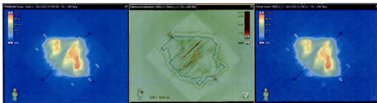
Rysunek 4.3.2: Rysunek przedstawia porównanie mapy fluencji planu zrekonstruowanego z mapą fluencji zmierzoną podczas pomiarów weryfikacyjnych. Z lewej strony mapa fluencji wygenerowana podczas procesu rekonstrukcji. Z prawej strony mapa fluencji zmierzona podczas pomiarów weryfikacyjnych. W środku porównanie obu map fluencji metodą Gamma. Niebieska linia oznacza pole leczenia, a czerwona pole leczenia z jedno centymetrowym marginesem. Zielony kolor oznacza, że współczynnik gamma jest mniejszy od jedności. W tym przypadku 'Area Gamma < 1.0' = 97.8%. Widoczne są również przecieki pomiędzy listkami kolimatora (czerwone paski w obszarze pola leczenia).
