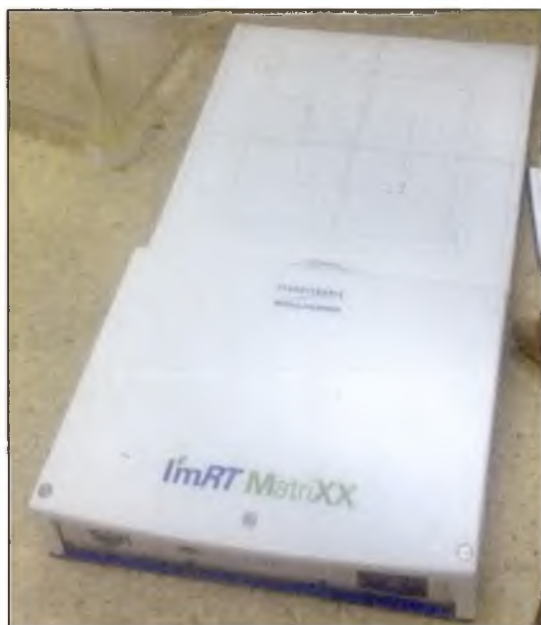
Rysunek 1.2.1: Matryca komór jonizacyjnych. Dane techniczne: 1020 komór jonizacyjnych (32x32), odległość pomiędzy środkami sąsiednich komór 7.62 mm, część aktywna 24.4x24.4 cm 2 , wymiary komory: \varnothing = 4.5 mm, h = 5 mm, V = 0.08cm 3 - firmy IBA.
