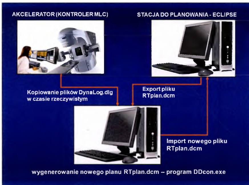
Rysunek 3.4.1: Schemat przepływu danych podczas procesu rekonstrukcji przy użyciu programu DDcon. Pliki DynaLog kopiowane są w czasie rzeczywistym z kontrolera MLC. Następnie eksportowany jest plan z systemu planowania leczenia w formacie RTplan.dcm. Przy pomocy opracowanego programu DDcon generowany jest nowy plik RTplan.dcm zawierający już zaktualizowane pozycje listków i kąta ramienia akceleratora. Taki plan importowany jest z powrotem do systemu planowania.
