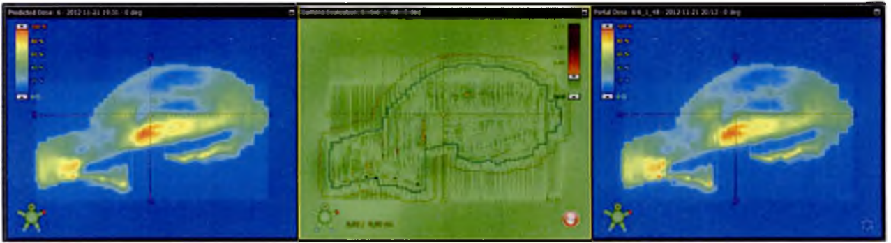
Rysunek 4.5.2.3: Rysunek przedstawia porównanie mapy fluencji jednego z pól planu weryfikacyjnego z mapą fluencji zmierzona podczas pomiarów weryfikacyjnych. Z lewej strony mapa fluencji planu weryfikacyjnego. Z prawej strony mapa fluencji zmierzona podczas pomiarów weryfikacyjnych. Po środku porównanie obu map fluencji metodą Gamma. Niebieska linia oznacza pole leczenia, a czerwona pole leczenia z jedno centymetrowym marginesem. Zielony kolor oznacza, że współczynnik gamma jest mniejszy od jedności. W tym przypadku 'Area Gamma < 1.0' = 98.9%. Widoczne są również znaczne, punktowe różnice pomiędzy porównywanymi mapami, dla których współczynnik gamma większy jest od jedności (kolor czerwony i ciemno czerwony). Jego maksymalna wartość wynosiła 4.47.
