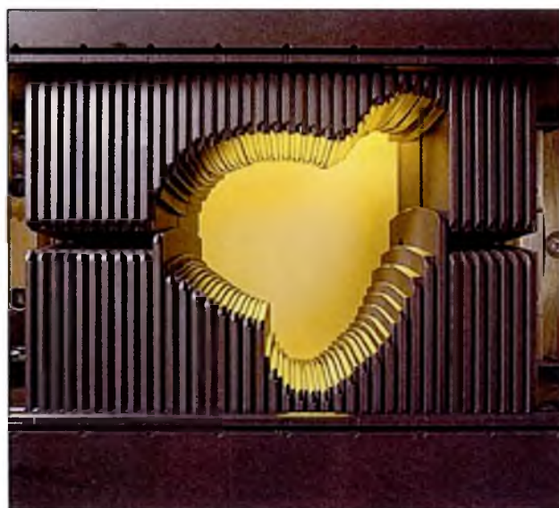
Rysunek 1.1: Kolimator 80 listkowy – MLC (Multi Leaf Collimator). Każdy z listków kolimatora napędzany jest własnym silniczkiem (rys. 1.2) poprzez przekładnię śrubową (rys. 1.3). Jak każde urządzenie mechaniczne MLC obarczone jest pewną tolerancją działania. W przypadku techniki IMRT dokładność ruchu listka wynosi 1 mm, a dla techniki VMAT 2.5 mm. (Varian Medical Systems)
