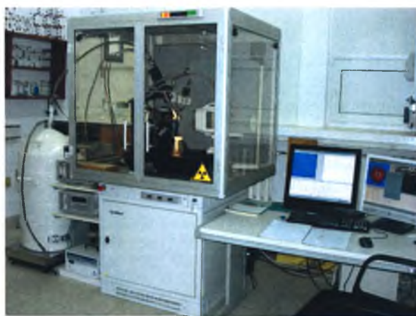
Rys. 2.1.1 Czterokołowy dyfraktometr rentgenowski Xcalibur o geometrii kappa firmy Oxford Diffraction (obecnie Agilent Technologies) z kamerą CCD Sapphire3 z Zakładu Fizyki Krysztalów, IF UŚI.
