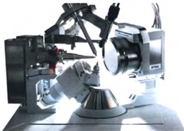
Rys. 2.4.2 Goniometr z dwiema zamontowanymi na stałe lampami rentgenowskimi (SuperNova firmy Agilent Technologies)
