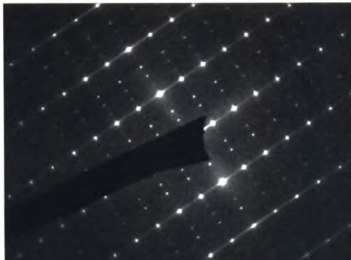
Rys. 3.2.5.2 Obraz dyfrakcji elektronów (SAED) na płaszczyźnie utworzonej pomiędzy wektorami 110 i 001 w przestrzeni odwrotnej. Wyraźnie widoczne są smugi rozpraszania dyfuzyjnego dla l = \pm 10n .
