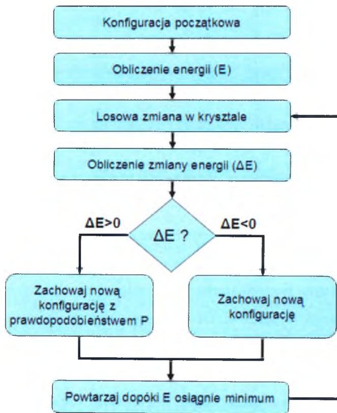
Rys. 1.2.2.1 Schemat algorytmu Metropolisia dla minimalizowania energii metodą Monte Carlo [Neder R.B. i Proffen Th., 2008].
