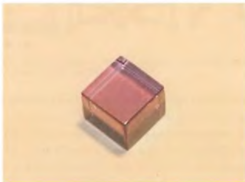
Rys. 27. Monokryształ YVO 4 otrzymany metodą Czochralskiego.
