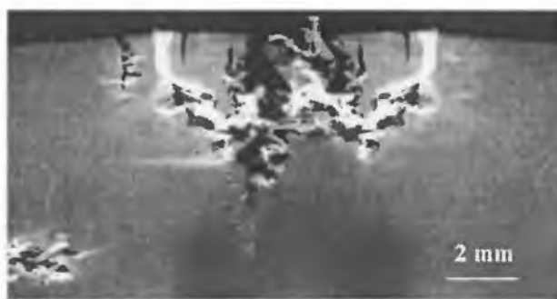
Rys. 10. Topogram otrzymany metodą Auleytnera monokryształu Si, refleks 224, promieniowanie Cu K\alpha_1 .
