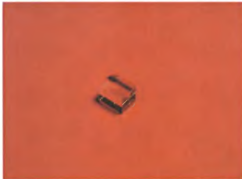
Rys. 24. Monokryształ Y_3Al_5O_{12} otrzymany metodą Czochralskiego.
