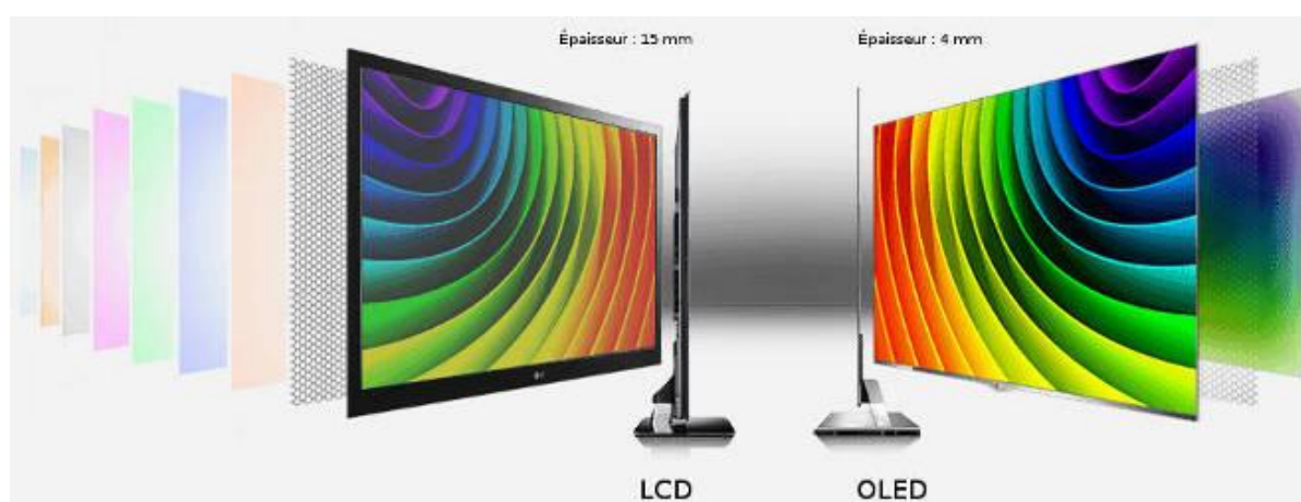
Zdjęcie 6. Architektura telewizora LCD i OLED [67].
