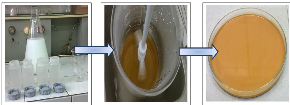
Rys. 20 Odmywanie krzemionki oraz nanoszenie prekursora palladu.
