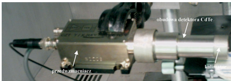
Rys. 5.7. Główna część układu detekcyjnego firmy Amptek — model XR-100T. Wymiary liniowe detektora CdTe: 3 mm × 3 mm × 1 mm. Rozdzielczość energetyczna układu detekcyjnego zależy od energii i wynosi 580 eV dla 14,4 keV i 1,2 keV dla 1 MeV (zob. http://www.amptek.com )
