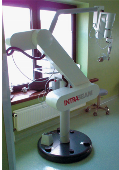
Rys. 5.5. Wysięgnik (tzw. ramię) umożliwiający precyzyjne manewrowanie igłą fotonową
