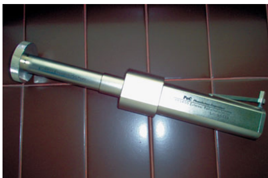
Rys. 5.4. Radiometr zewnętrzny promieniowania X generowanego przez układ Intrabeam
