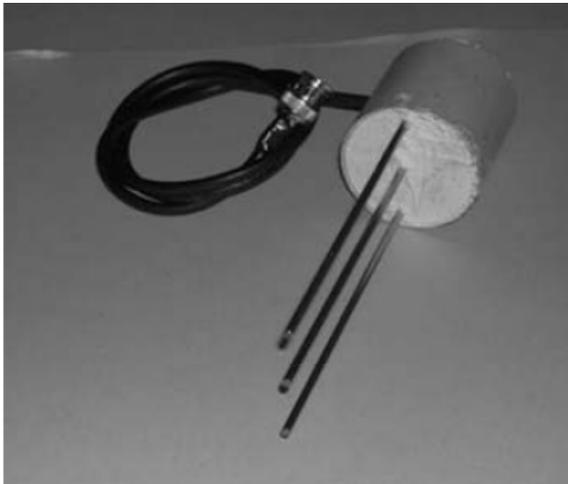
Fig 3- Una delle sonde TDR utilizzate per strumentare i provini
