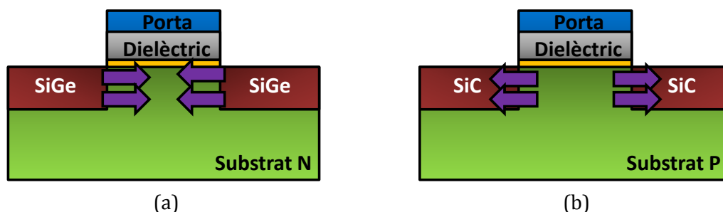
Fig. 1.7 Esquema de transistors amb estrès mecànic induït amb SiGe per a pMOS (a) i SiC per nMOS (b) a la font i drenador.
